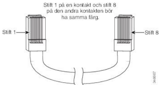
Figur 53. Identifiera en korsad kabel
