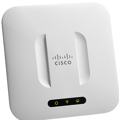
Figura 2. Punto de acceso de dos radios con switch de 5 puertos Cisco WAP351 Wireless-AC/N
