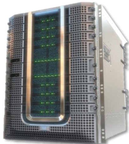
Cisco cBR-8 前面外観 13RUにCMTS / RF-Switch / Edge QAMを凝縮
