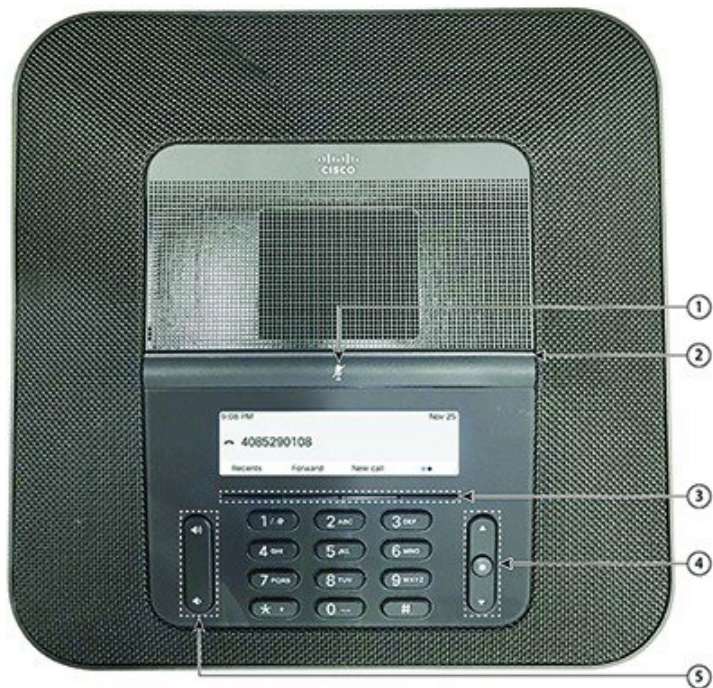
Figura 3: Botões e funcionalidades do Telefone IP de conferência Cisco 8832
