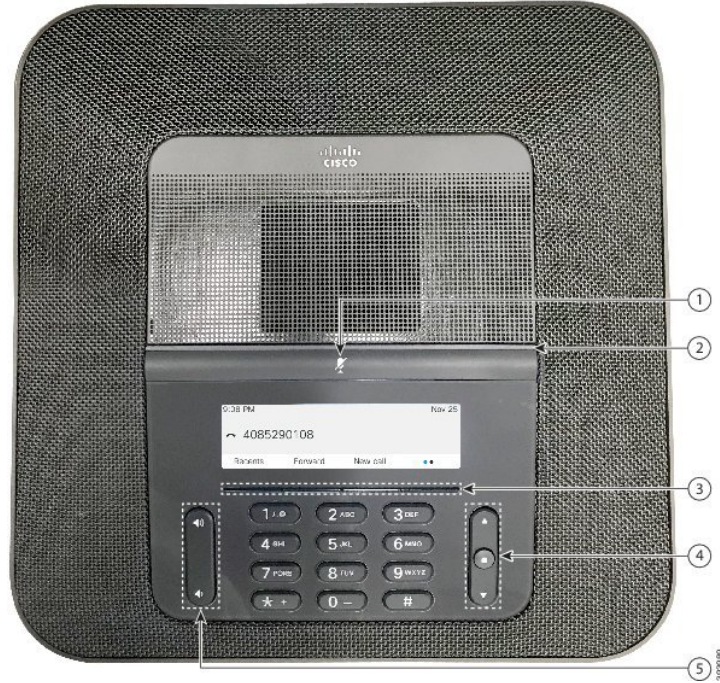
الشكل 3: أزرار هاتف مؤتمر Cisco IP 8832 والميزات التابعة له
