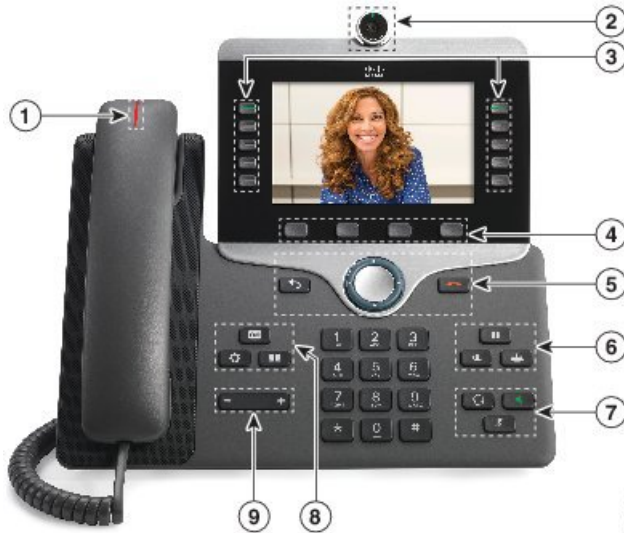
Figura 1: Botones y hardware del teléfono IP 8845 de Cisco
