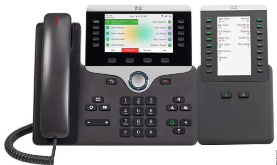
图 4: 采用单 LCD 屏幕的按键扩展模块
