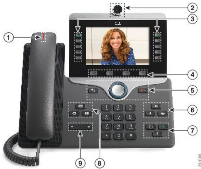
Illustration 2 : Boutons et matériel du téléphone IP Cisco 8845
