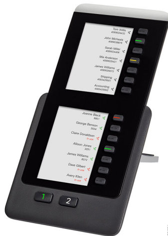
Illustration 15 : Module d'extension de touches pour téléphone Cisco IP Phone 8851/8861
