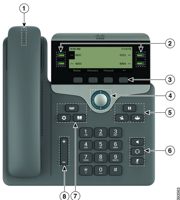
Slika 2: Gumbi i značajke modela Cisco IP telefon serije 7800
