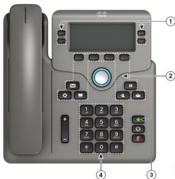
Figura 13: Funcions d'accessibilitat per a persones amb mobilitat reduïda—Telèfons IP 6841 multiplataforma de Cisco Mostrades
