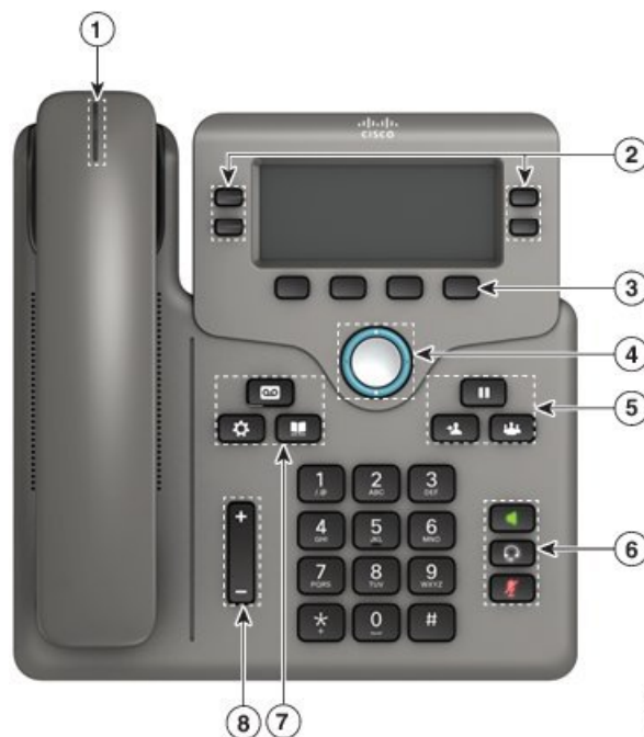
Figuur 4: Knoppen en functies van Cisco IP Phone 6841 en 6851 voor meerdere platforms
