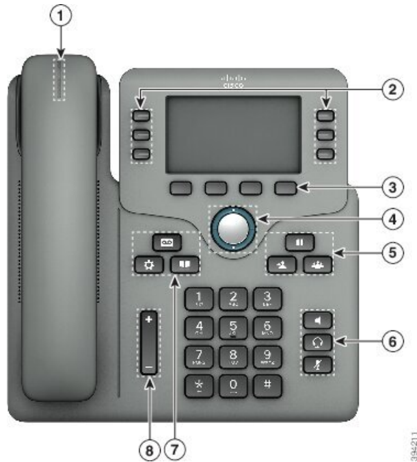
图题 5: Cisco IP Phone 6871 多平台電話 按鈕和功能
