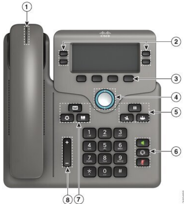
图 4: Cisco IP 電話 6841、6851 和 6861 多平台電話按鈕及功能
