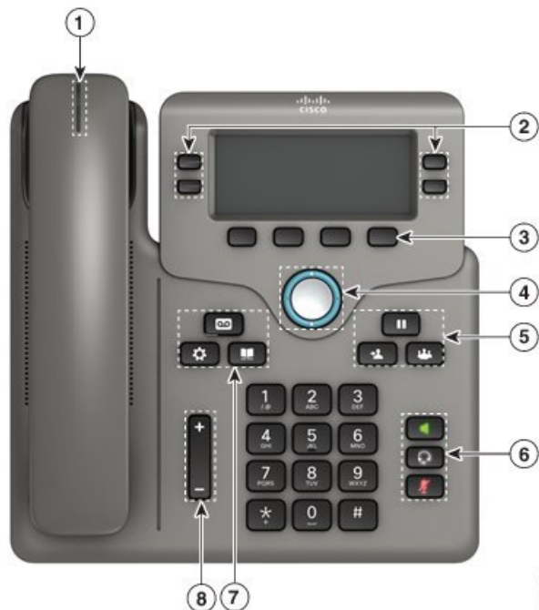
Figura 4: Botones y funciones de los teléfonos multiplataforma Cisco IP Phone 6841, 6851 y 6861.
