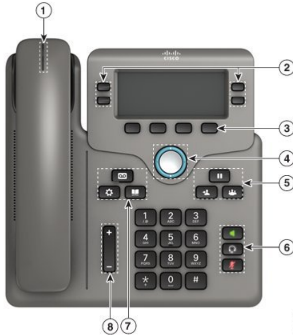
图 4: Cisco IP Phone 6841、6851 和 6861 多平台电话按键和功能
