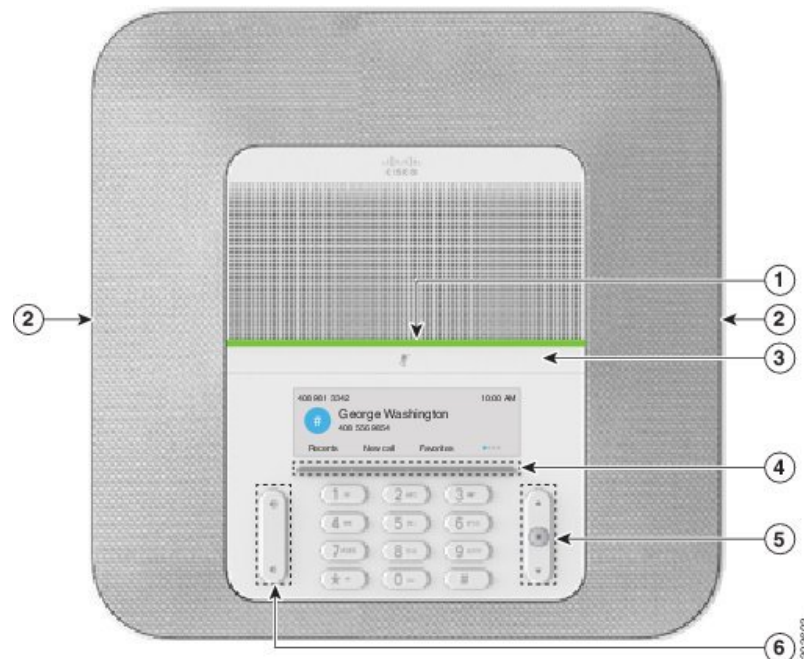
Figura 2: Pulsanti e funzionalità del telefono IP per chiamate in conferenza Cisco 8832
