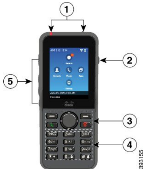
Figur 2: Trådløs Cisco IP-telefon 8821 Knapper og maskinvare
