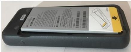
En la siguiente imagen, se muestra la misma batería hinchada cuando se pone la cubierta. Observe que el centro de la cubierta está arqueado. Los cierres en la parte central de la cubierta no se podrán conectar fácilmente.
