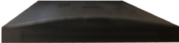
En la siguiente imagen, se muestra una batería hinchada en el compartimiento de la batería. Observe que la batería no está al nivel de las paredes del compartimiento alrededor del perímetro de la batería.
