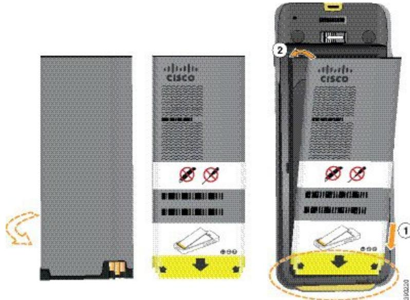
La batería tiene contactos metálicos que deben conectarse con los contactos del compartimento de la batería. La batería también tiene una flecha en la parte inferior y el logotipo de Cisco en la parte superior.
