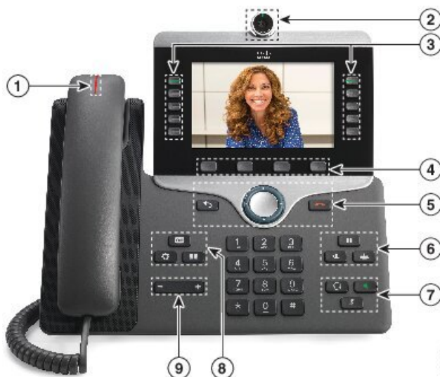
Obrázek 3: Tlačítka a hardware Cisco IP telefonu 8845
