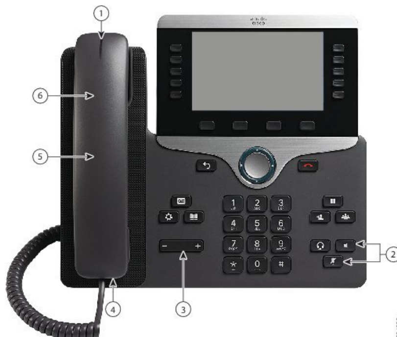
Obrázek 6: Funkce usnadnění ovládání pro sluchově postižené – na obrázku je Cisco IP telefon 8861
