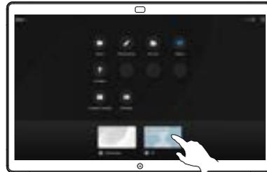
3 Desconecte el origen para dejar de compartirlo en el dispositivo. Si está compartiendo de manera inalámbrica, toque la pantalla y luego toque **Detener vista previa**.
