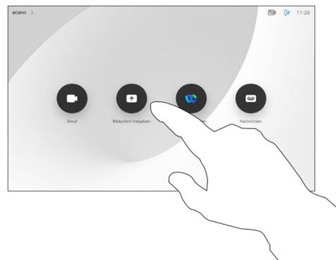
Verbinden Sie das Quellgerät mit einem geeigneten Kabel mit dem Videogerät, stellen Sie sicher, dass es eingeschaltet wurde, und tippen Sie auf **Freigeben**.
