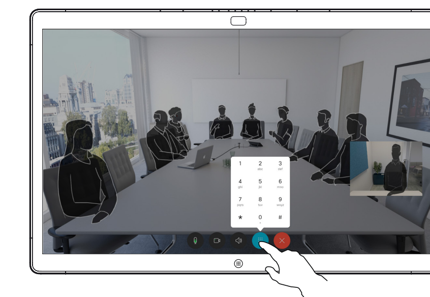
Lors d'un appel, effleurez l'écran pour générer les boutons comme illustré. Appuyez sur le bouton bleu pour ouvrir le clavier numérique.
