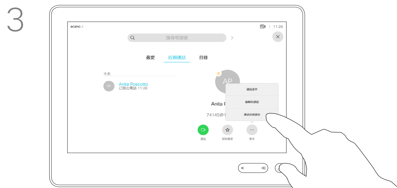
找到項目後，點選該項目以顯示「通話」功能表。在「通話」功能表中，點選更多，然後點選通話詳細資料，如圖所示。
