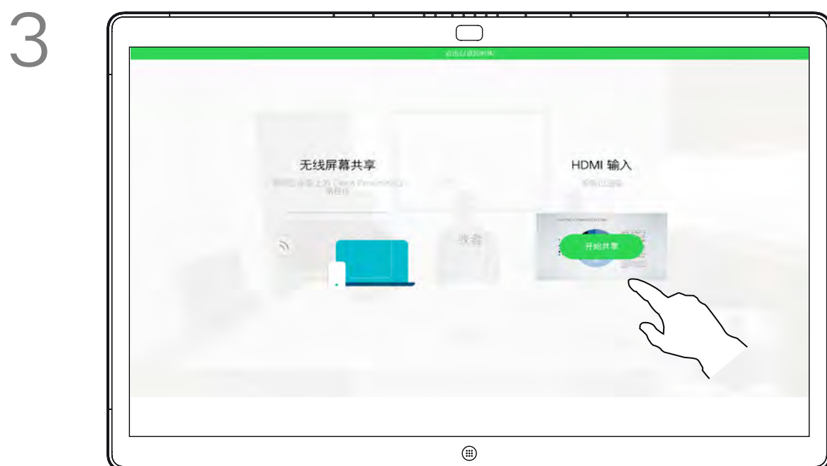
3 通过电缆或 Proximity 连接您的演示源，然后点击开始共享。此时，您可以共享演示源中的选定内容。
