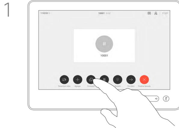
Conecte la fuente al dispositivo de vídeo con un cable adecuado, asegúrese de que se ha encendido y toque **Compartir**.
