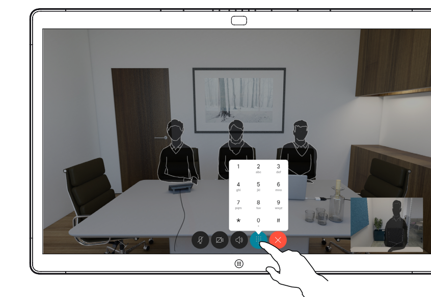
Durante una llamada, toque la pantalla para mostrar los botones que se indican. A continuación, toque el botón azul para mostrar el teclado numérico.
