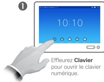
1 Effleurez **Clavier** pour ouvrir le clavier numérique.
