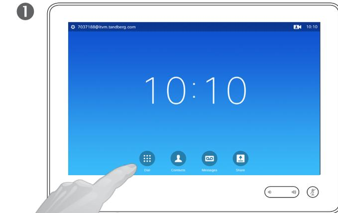
Effleurez **Clavier** pour ouvrir le clavier numérique.
