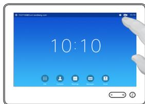
Effleurez **Caméra** pour ouvrir le menu de réglage de la caméra.
