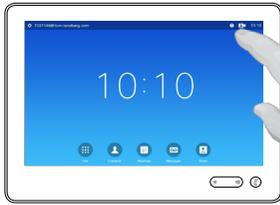
Effleurez **Caméra** pour visualiser le résultat de vos réglages de caméra.
