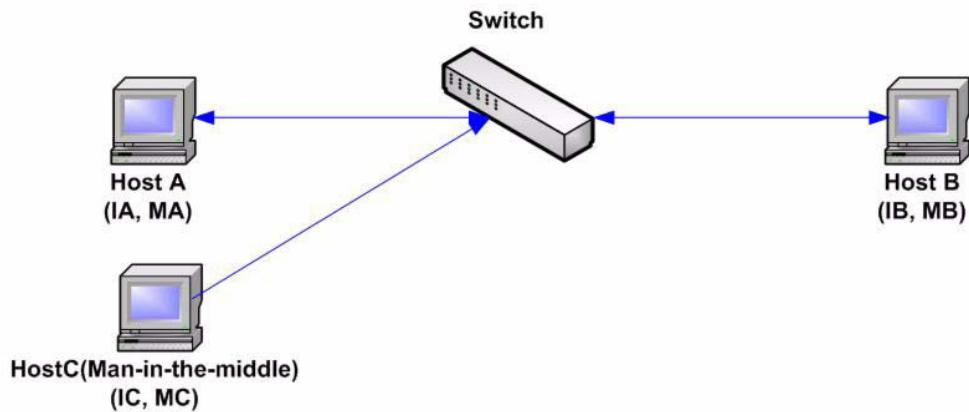
主机 A、B 和 C 连接至交换机接口 A、B 和 C，它们全部位于同一个子网上。其 IP、MAC 地址在括号中显示；例如，主机 A 使用 IP 地址 IA 和 MAC 地址 MA。当主机 A 需要在 IP 层与主机 B 进行通信时，将广播一条有关与 IP 地址 IB 相关联的 MAC 地址的 ARP 请求。主机 B 使用一个 ARP 回复进行回应。交换机和主机 A 使用主机 B 的 MAC 和 IP 更新其 ARP 缓存。
