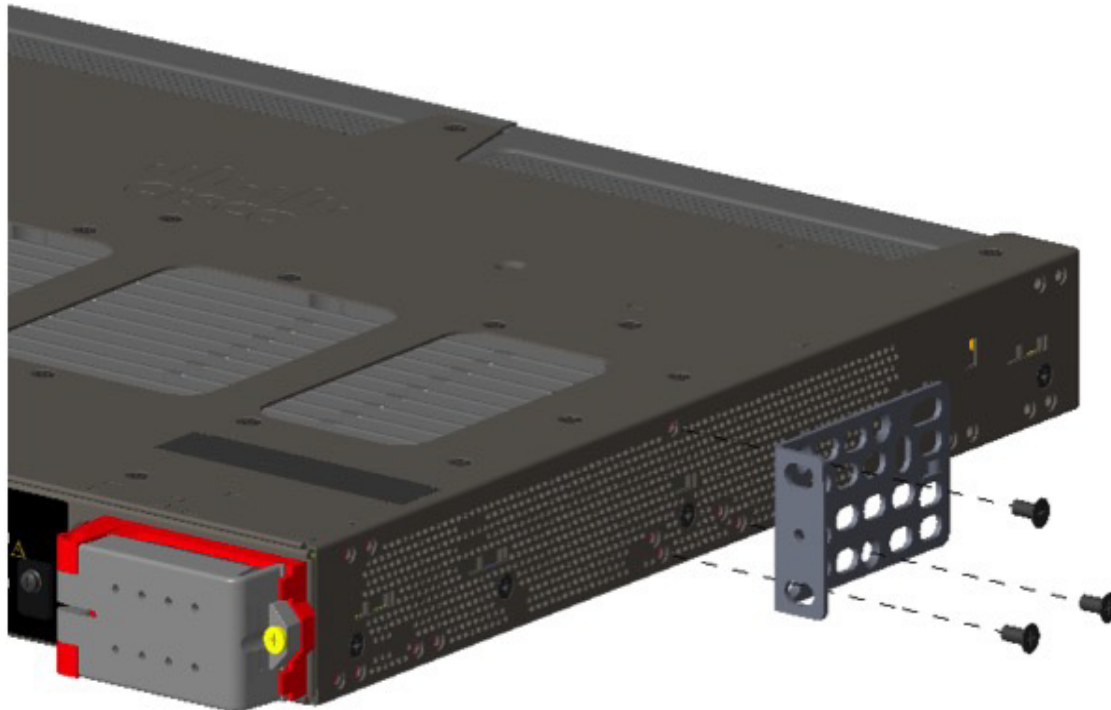
Рис. 8 Крепление кронштейнов для 19-дюймовых стоек (крепление в середине)
