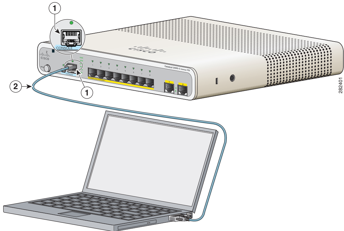
Figure C-1 Connexion du câble de console
