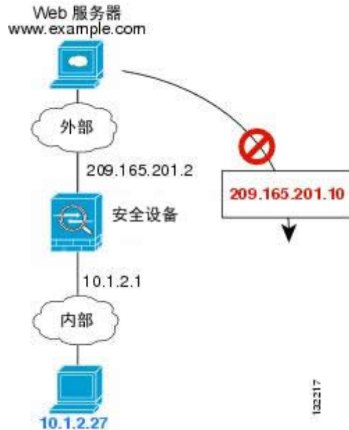
图 18: 远程主机尝试向映射地址发起连接
