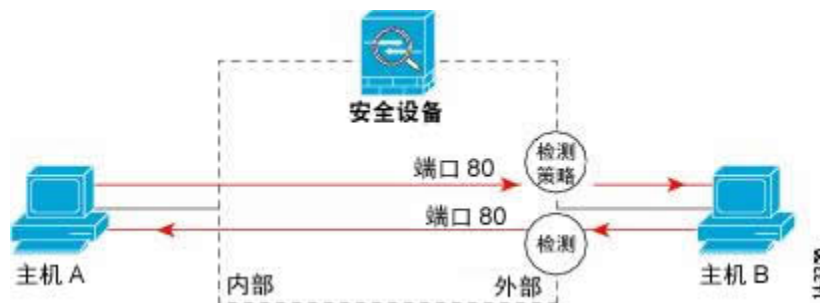
图 46: HTTP 检测和 QoS 策略管制
