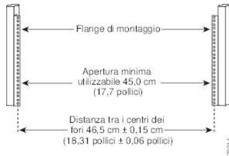
Figura 6: Verifica delle dimensioni del rack per apparecchiature
