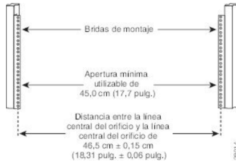
Figura 6: Comprobación de las dimensiones del rack del equipo
