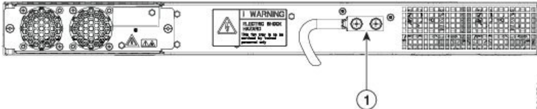
Figura 9: Fissare un terminale di messa a terra alla parte posteriore del router
