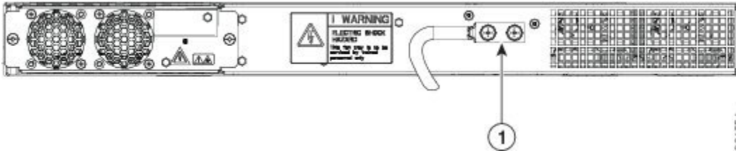
Figura 9: Instalación de un terminal de toma a tierra en la parte posterior del router
