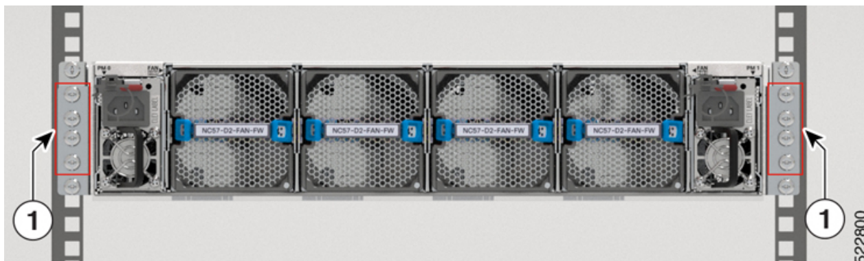
Figura 75: Remover os parafusos do suporte do deslizador - Configuração na saída do lado da porta
