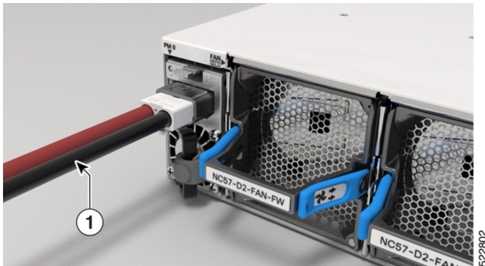
Figura 91: NCS-57D2 - Ligar o cabo de alimentação DC
