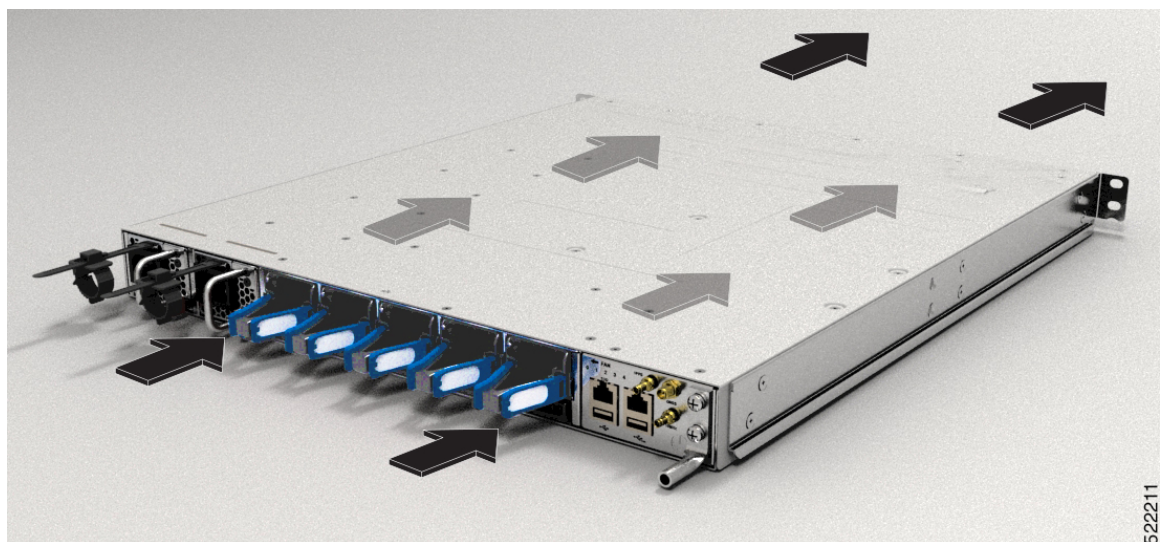
Figura 28: Direção do fluxo de ar de saída do lado da porta
