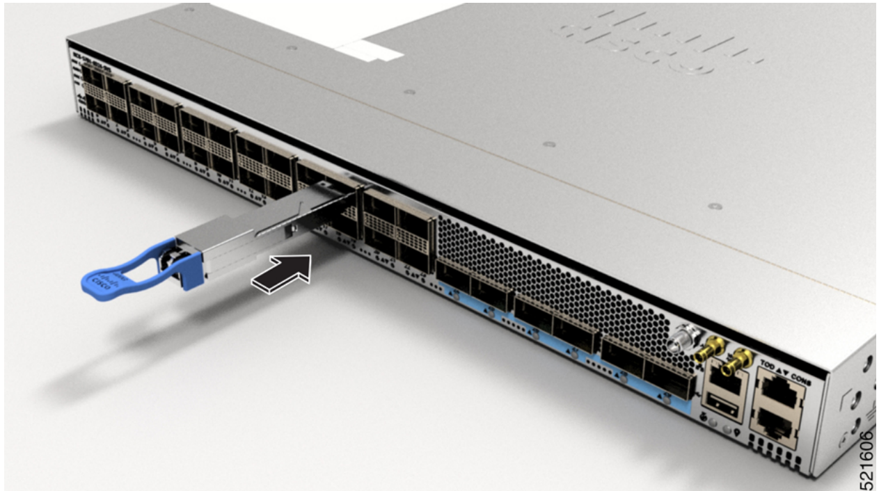
Figura 102: Introduzir o Módulo do Transceptor QSFP-DD
