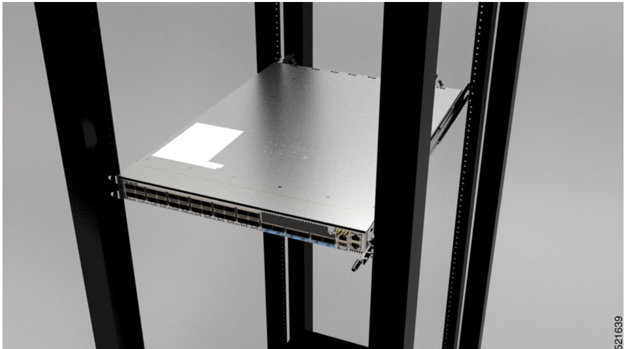
Figura 50: Montagem em rack de 4 postes
