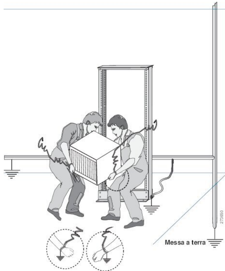
Figura 31: Movimentazione dello chassis
