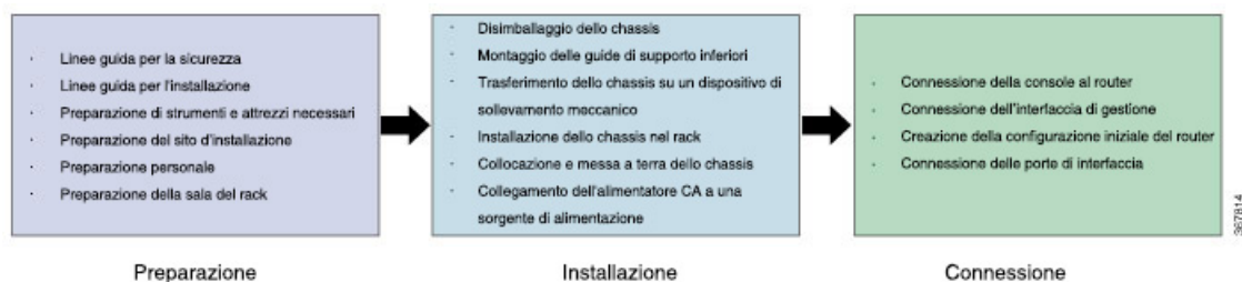
Figura 25: Flusso di lavoro per l'installazione
