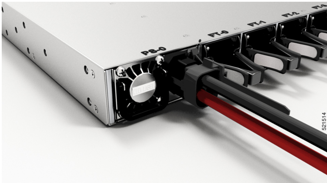
Figura 89: NCS-57B1 - Collegamento dell'alimentazione CC
