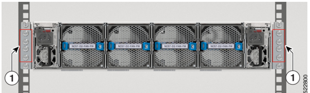
Figura 75: Rimozione delle viti dalla staffa di scorrimento - Configurazione con scarico lato porte
