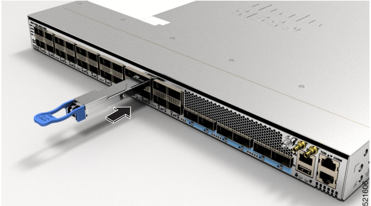
**Paso 6** Sujetando la lengüeta, asiente completamente el transceptor en el socket del transceptor del módulo hasta que haga clic.
