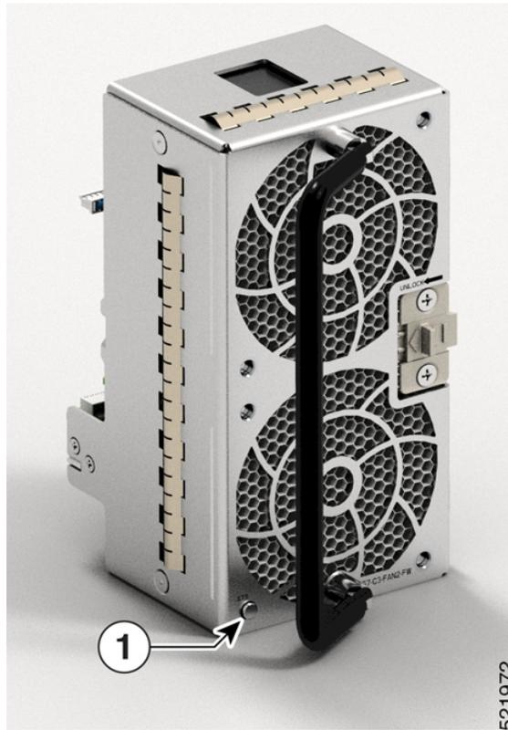
El LED de la bandeja del ventilador del NCS-57D2 se encuentra en la esquina inferior derecha del módulo.
