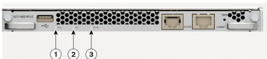
Abbildung 127: LEDs für NC57-MOD-RP2-E
