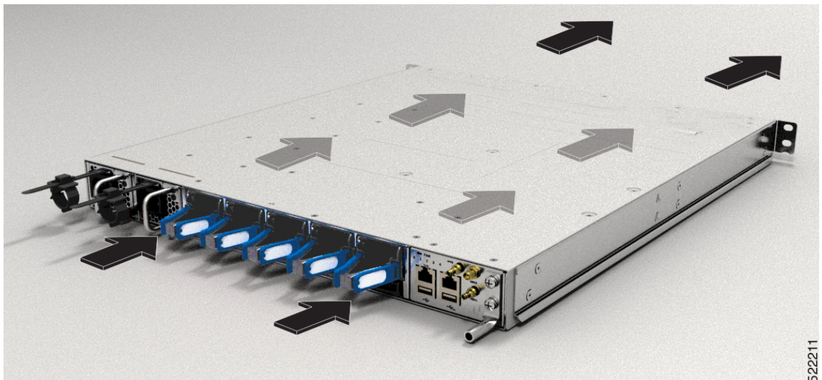
Abbildung 28: Luftstromrichtung am Port-seitigen Auslass
