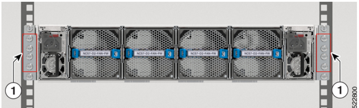
Abbildung 75: Entfernen der Schrauben von der Gleitschienenhalterung – Port-seitige Auslasskonfiguration
