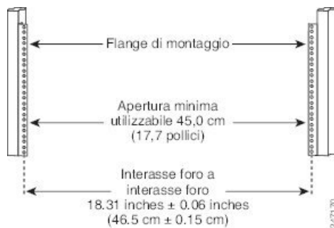
Figura 113: Verifica delle dimensioni del rack per apparecchiature
