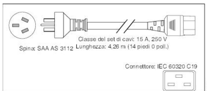
Figura 37: Cavo di alimentazione CA CAB-7513ACI=
