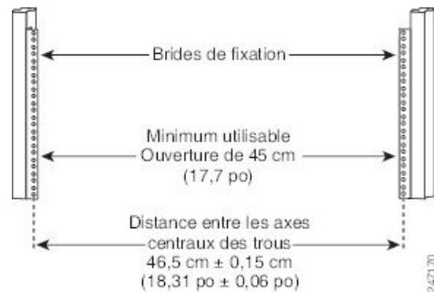
Illustration 113 : Vérifier les dimensions du rack
