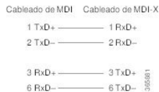
Figura 65: Patillaje de cable directo a un hub, repetidor o switch
