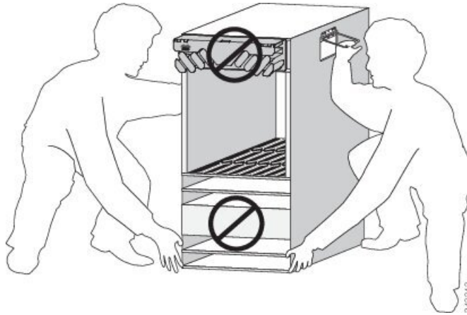
Figura 121: Posiciones de elevación correctas
