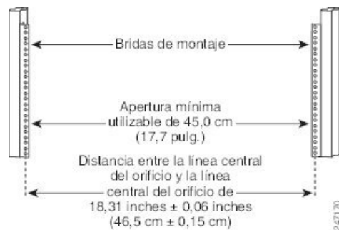
Figura 113: Comprobación de las dimensiones del rack del equipo
