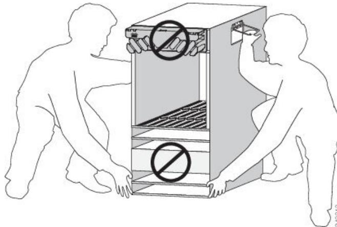
**Vorsicht** Ergreifen Sie beim Anheben des Router-Chassis nicht das Kartengehäuse oder das Lufterlassgitter (siehe folgende Abbildung).
