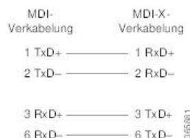
Verwenden Sie zum Anschluss eines Routers am RJ-45-Port die Pinbelegung des Crossover-Kabels wie in der Abbildung unten gezeigt.
