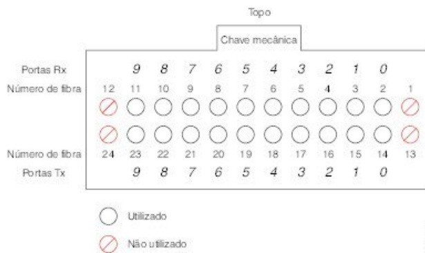
Figura 92: Saídas de pinos do conector MPO-24 de 100 Gigabits
