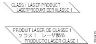
Figura 42: Etiquetas de aviso de laser para porta de modo único
