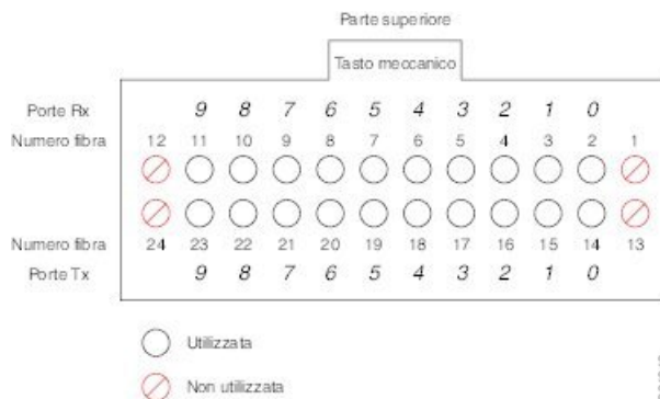
Figura 92: Pinout del connettore MPO-24 100 Gigabit
