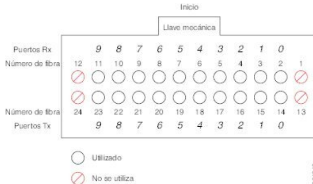
Figura 92: Diagrama de pines del conector de 100 Gigabit MPO-24
