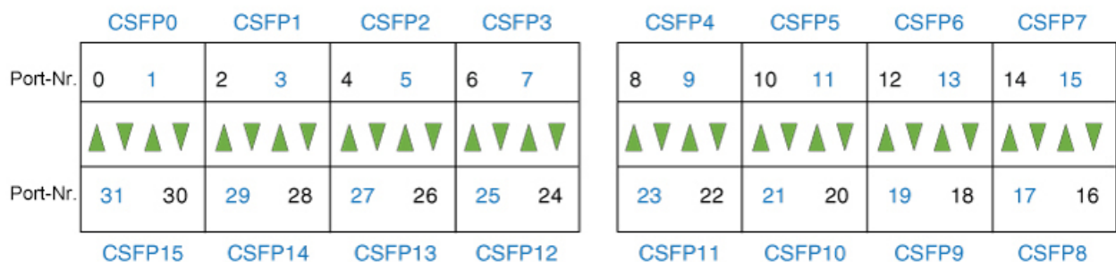
Abbildung 40: CSFP-Ports an einem modularen Gigabit-Ethernet-Port-Adapter, 32 Ports, mit MACsec
