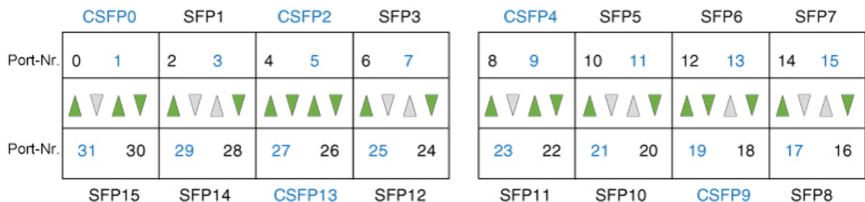
Abbildung 39: SFP- und CSFP-Ports an einem modularen Gigabit-Ethernet-Port-Adapter, 32 Ports, mit MACsec
