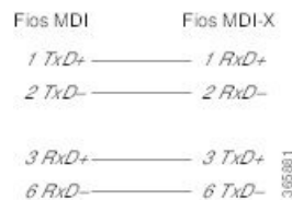
Figura 14: Distribuição de pinos do cabo de passagem direta para um hub, repetidor ou switch
