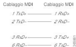
Figura 14: Pinout di un cavo diretto (straight-through) per hub, ripetitori o switch
