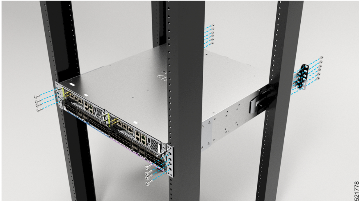
Figura 84: Cisco ASR 9902: serrare le viti alle guide del rack (rack da 19 pollici a 4 montanti) - Vista posteriore
