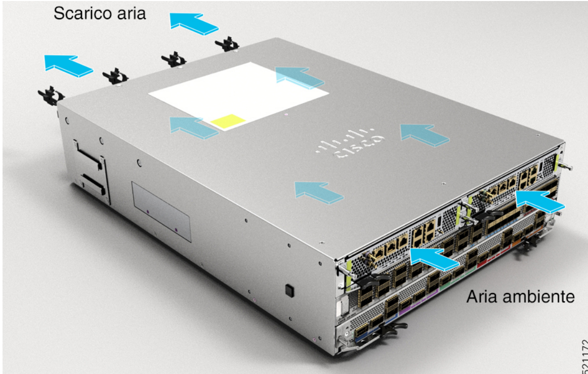
Figura 21: Percorso del flusso di aria attraverso il router Cisco ASR 9903
