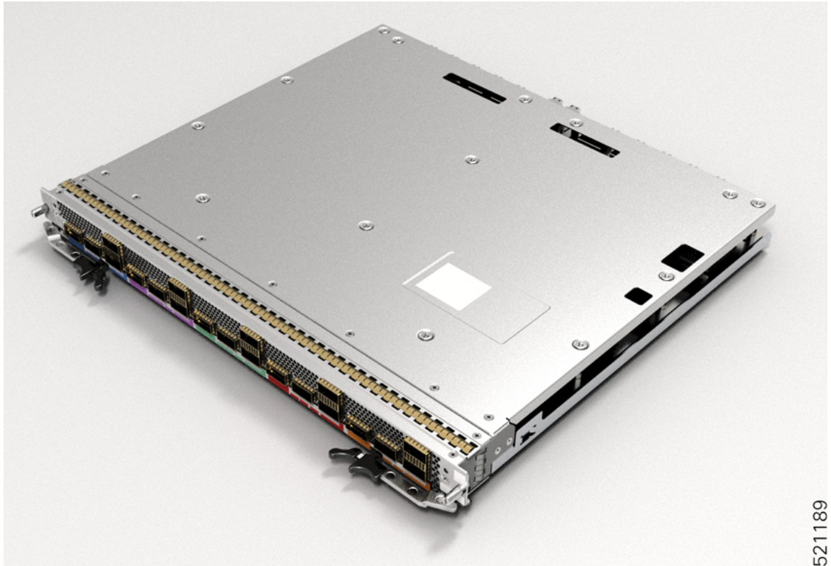
Figura 146: Scheda di espansione porte ASR 9903 da 2T - Vista dall'alto
