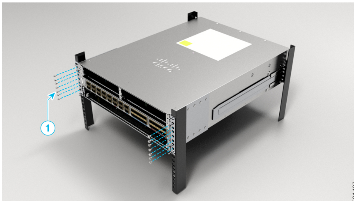
Illustration 27 : Routeur Cisco ASR 9903 monté sur un rack à 4 montants
