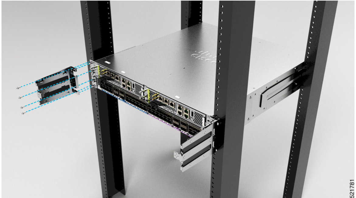
Illustration 126 : Installation et retrait du support de gestion des câbles pour le routeur Cisco ASR 9902
