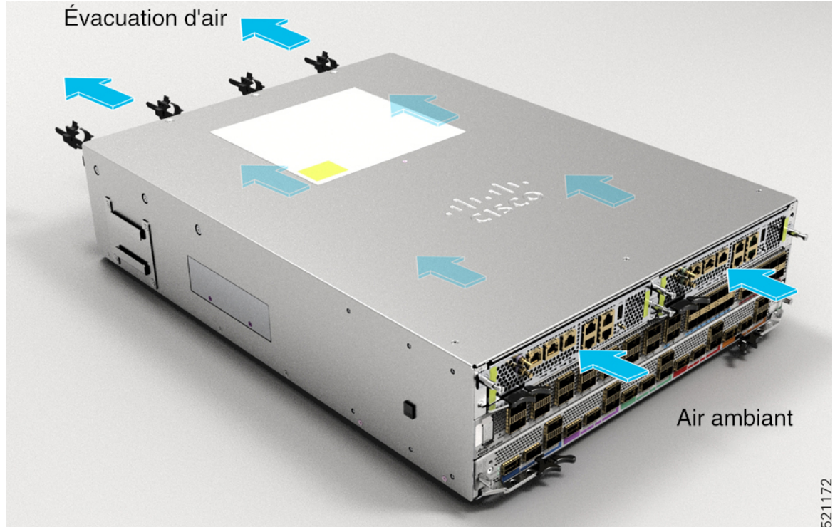
Illustration 21 : Cheminement de l'air dans le routeur Cisco ASR 9903
