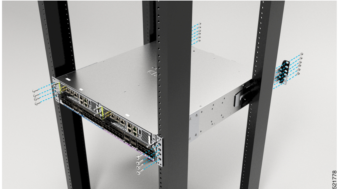
Illustration 84 : Cisco ASR 9902 : serrage des vis sur les rails du rack (rack 19 pouces à 4 montants) – Vue arrière
