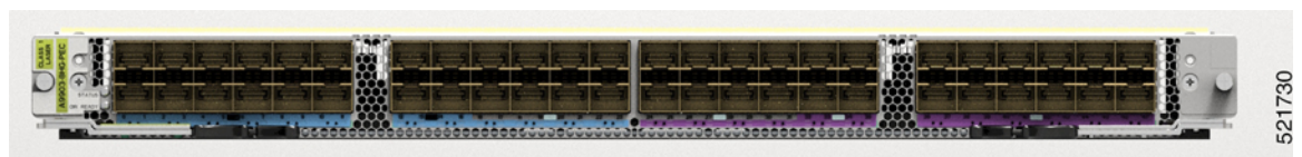
Illustration 143 : Carte d'extension de port ASR 9903 0,8 T – Disposition des ports
