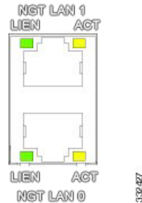
Illustration 105 : DEL d'activité des ports de gestion de réseau local
